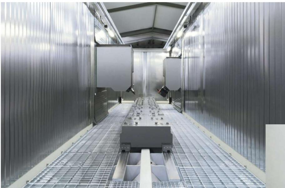
Bearbeitung von unten durch die Verriegelung von schweren Winkelfräsköpfen über eine Vierpunktstützung
