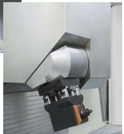
Blick in den Arbeitsraum: Die Arbeitsspindeln verfahren auf gegenüberliegenden Fahrständern. Sie sind jeweils um die X-Achse schwenkbar, so dass beliebige Konturen, auch mit Schrägen, bearbeitet werden können
