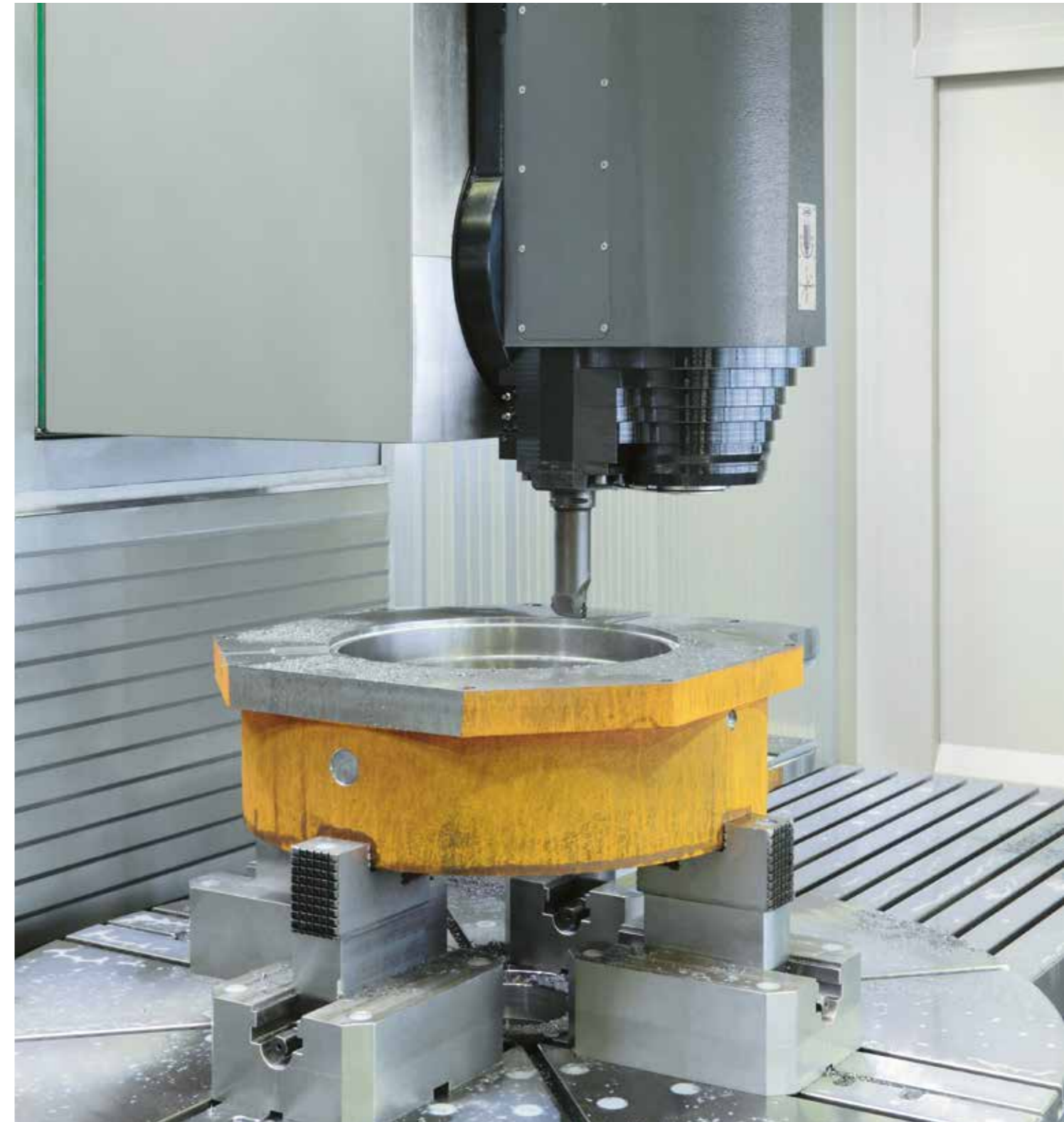
Fräsen und Drehen in einer Aufspannung durch die zusätzlich neben der Arbeitsspindel fest angebrachte Drehstahlhalterung mit CAPTO Aufnahme für Drehwerkzeuge
