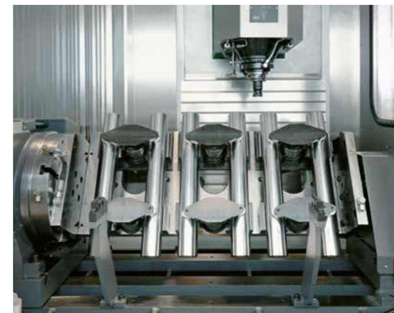
Komplexe hydraulische Spannvorrichtung in Modulbauweise von AXA für schnelles Umrüsten und gesicherten Späneabfluss
