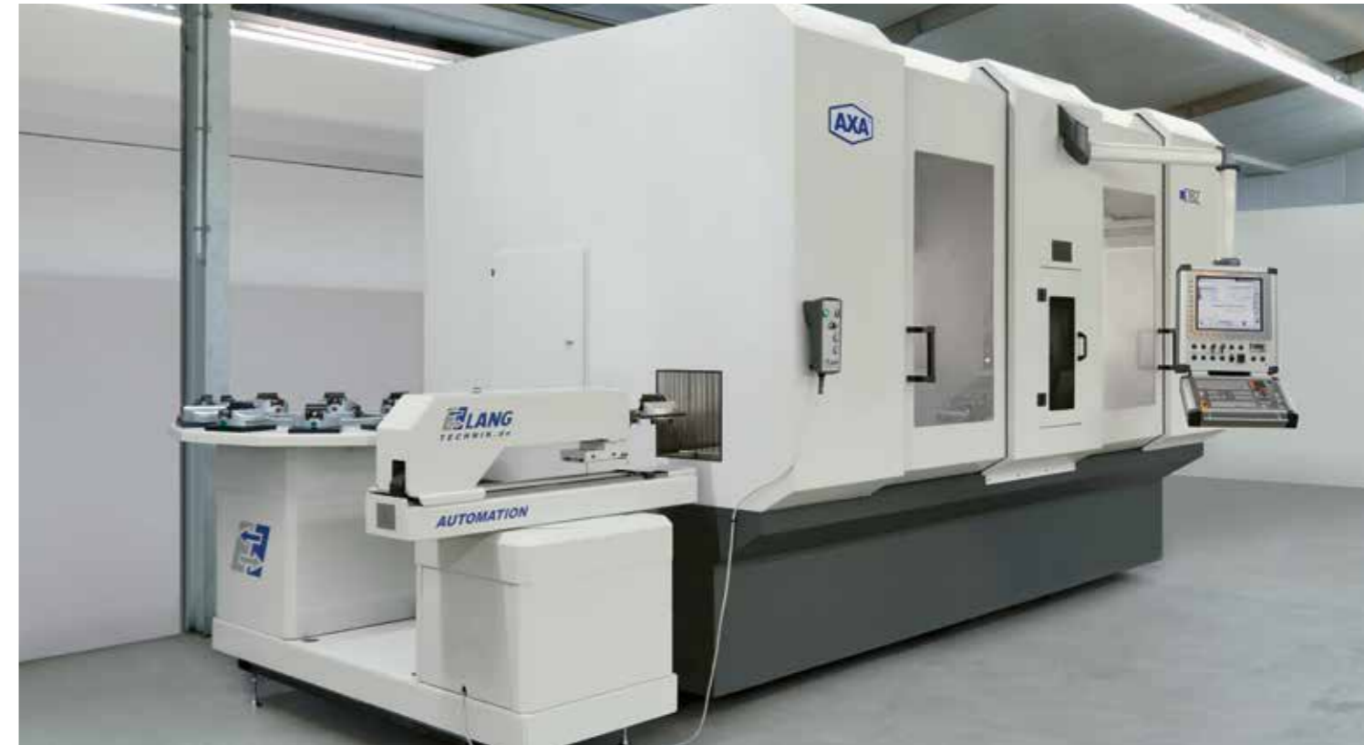
Schnelle und einfache Automation durch eine kompakte Gesamtlösung mit Werkstückspeicher, Handlingsystem und Nullpunktspannung
