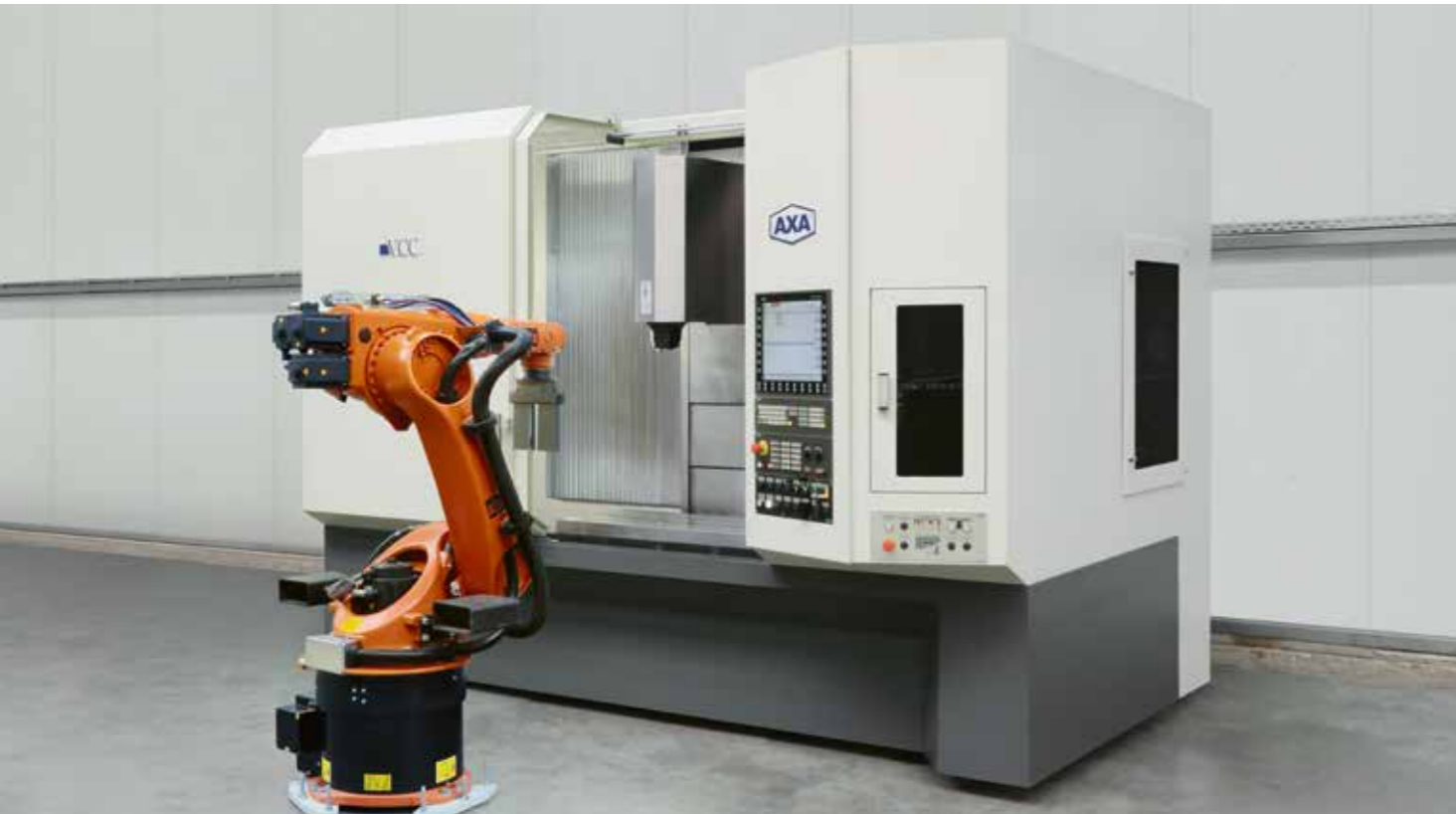
Vor dem Bearbeitungszentrum installierter Industrieroboter für die direkte Be- und Entladung der Maschine mit Werkstücken
