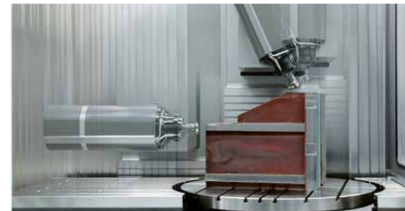
Die Schwenkspindel im Einsatz: durch sie wird die Bearbeitung im Bereich von \pm 100^\circ möglich
