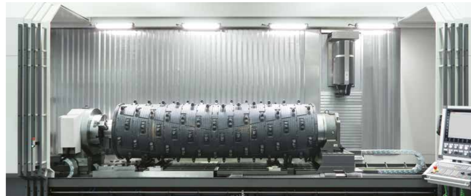
Version 3: die Rundtische werden in den Arbeitsraum gefahren und die Werkstücke direkt über die Rundtische aufgenommen - Da einer der Rundtische über den festen Maschinentisch verfahren kann, lässt sich die Werkstücklänge flexibel einstellen
