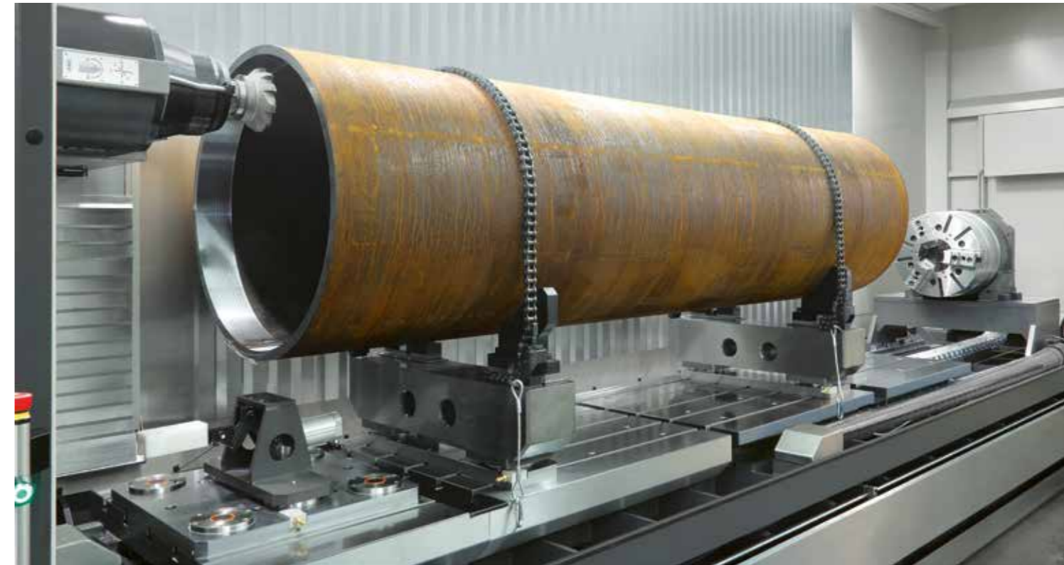
Version 2: die Rundtische werden in die äußeren Parkpositionen gefahren und über unterschiedliche Spannelemente, aufgenommen in den Nullpunktspannsystemen, können die Werkstücke im Arbeitsraum flexibel positioniert werden
