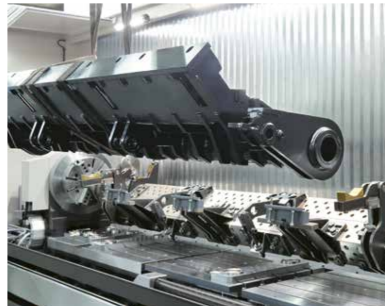
Die Werkstücke können nun direkt über die hydraulische Spannvorrichtung aufgenommen werden - Über dem Arbeitsraum öffnende Schiebetüren gewähren dabei eine optimale Beladung von oben
