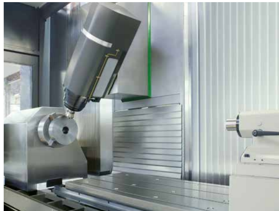
Drehspindel mit 1500 1/min in Kombination mit einem manuell in Längsrichtung über den festen Maschinentisch verfahrenen Reitstock für unterschiedlich lange Drehwerkzeuge
