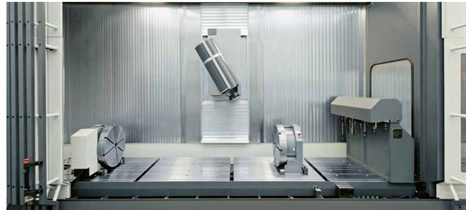
Rundtische im Gantrybetrieb für Spannbrücken sowie eine zusätzliche, abnehmbare Pick-Up Station links für Pendel- oder rechts für Langbettbetrieb
