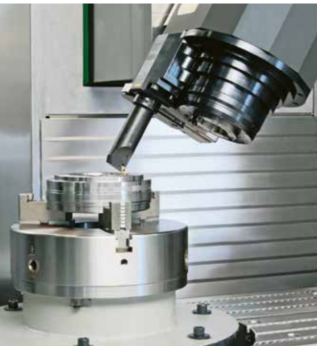
Neben vertikaler und horizontaler Spindelstellung sind auch alle Zwischenwinkel für die Position des Drehstahls einstellbar
