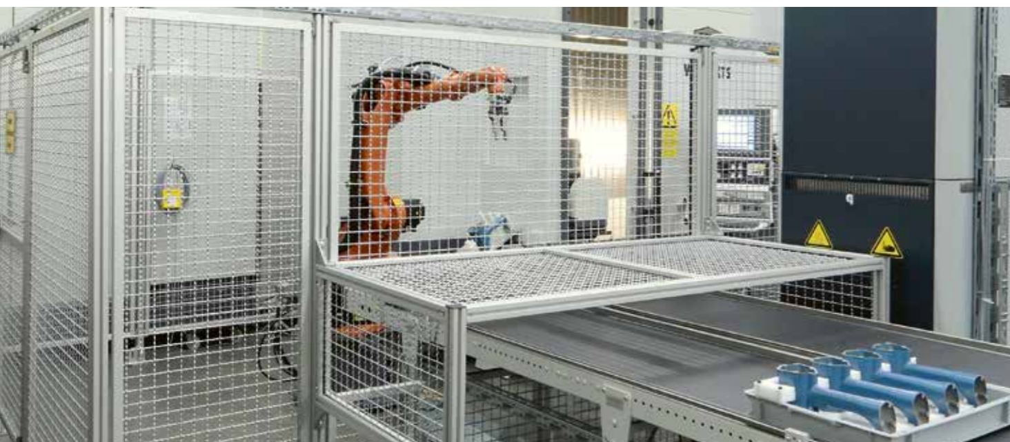
Der Zwischenspeicher an der Maschine reduziert die Rüstzeiten bei langen Transportwegen des Roboters - Während der Bearbeitung der Maschine tauscht der Roboter die Werkstücke aus dem Zwischenspeicher und dem Werkstückspeicher aus
