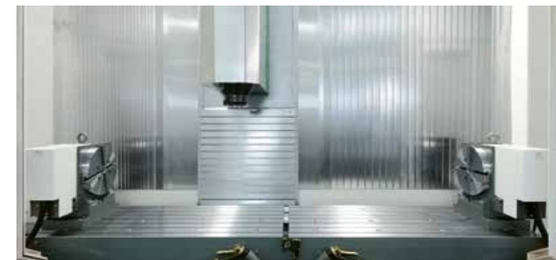
Rundtisch im linken und rechten Arbeitsraum oder Verwendung der Rundtische im Gantrybetrieb für Spannbrücken im Langbettbetrieb
