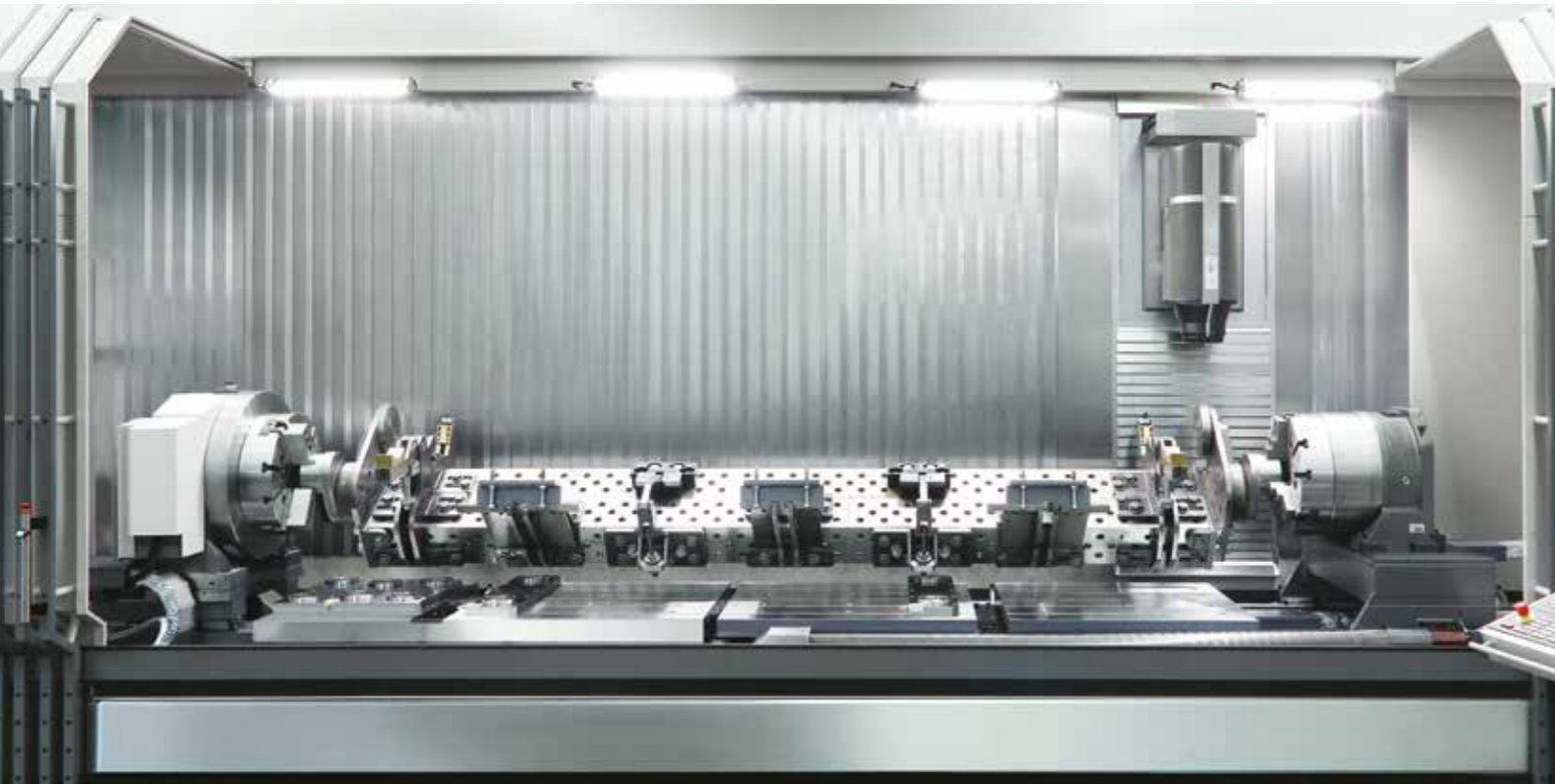
Mehrzweck-Arbeitsraum der Extraklasse! In X verfahrbare Rundtische und Nullpunktspannsysteme auf den festen Maschinentischen erlauben eine schnelle und flexible Umrüstung auf die verschiedenen Werkstückanforderungen
