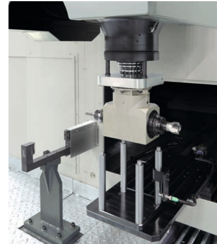
Vertikales Pick up Magazin – fest im Arbeitsraum integriert oder optional aus dem Arbeitsraum heraus verfahrbar
