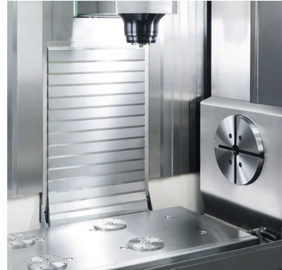
Bei sehr kleinen Arbeitsräumen integrieren wir den Rundtisch seitlich außerhalb des Maschinentisches
