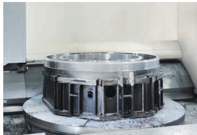
Fräsen und Drehen in einer Aufspannung: 5-Seiten- und 5-Achs-Bearbeitung großvolumiger Werkstücke durch Schwenkkopf und Rundtisch mit Planscheiben-Durchmesser 2800 mm
