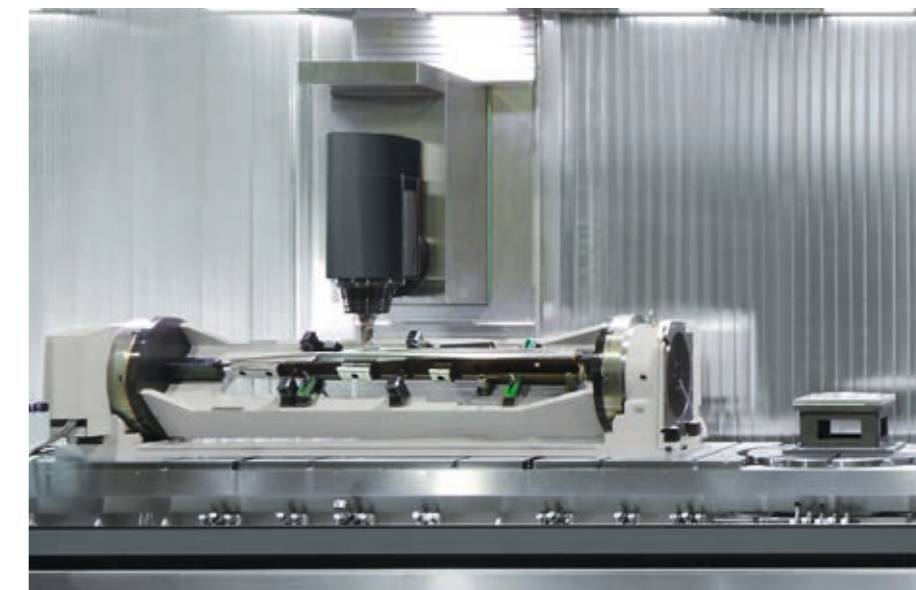
Zwei im Synchronbetrieb arbeitende NC-Rundtische sorgen für die verdrehsteife Aufhängung der Spannbrücke
