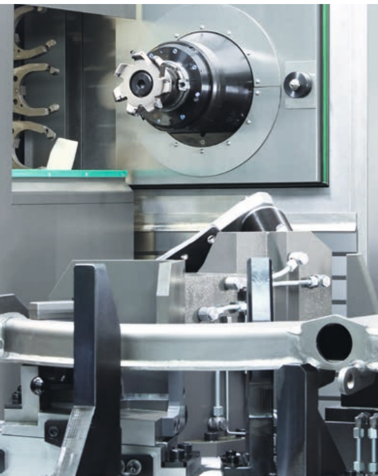
Der Werkzeugwechsel findet außerhalb des Arbeitsraumes statt
