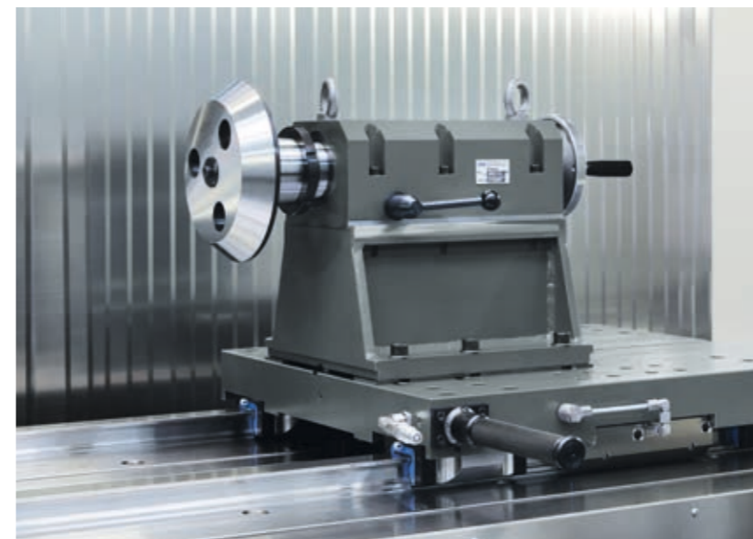
Über dem Maschinentisch verschiebbarer Reitstock
