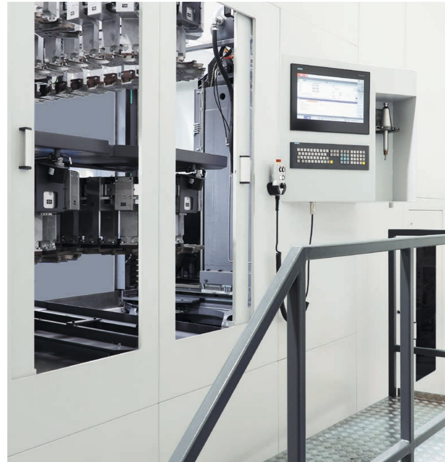
Bei mehr als einem XTS-Turm erfolgt die Werkzeugbestückung von hinten anstatt von der Seite
