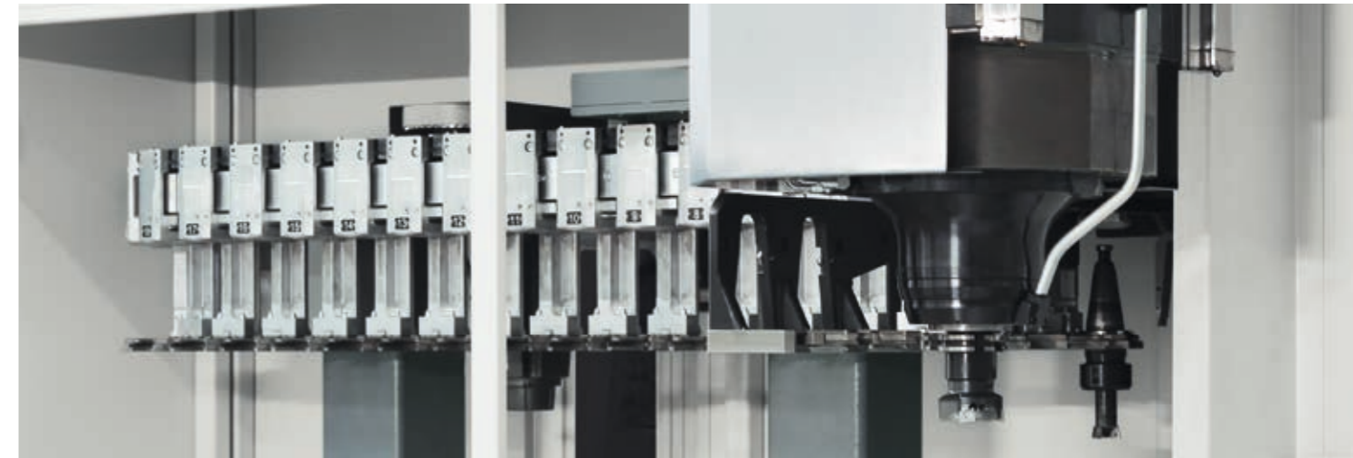
Die Magazinkette befindet sich geschützt hinter der Arbeitsraumverkleidung
