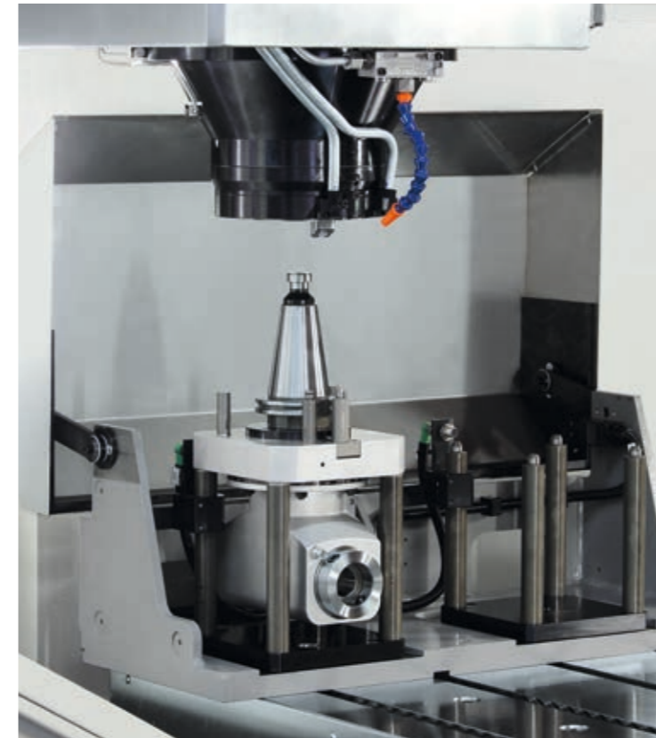
Vertikales Pick up Magazin – fest im Arbeitsraum integriert oder optional aus dem Arbeitsraum heraus verfahrbar
