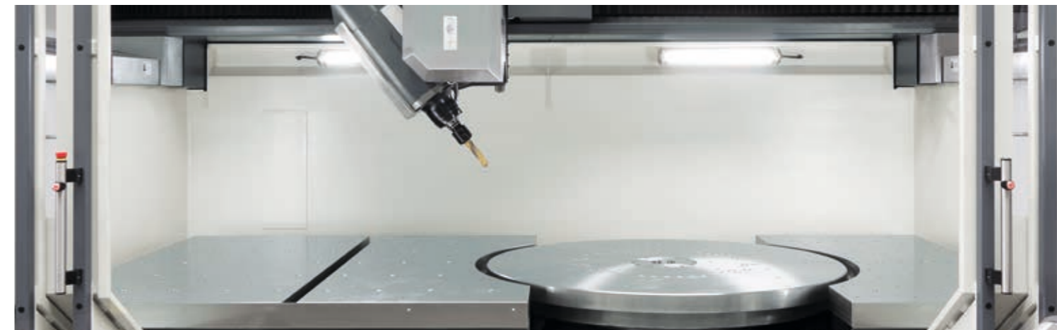
Im Maschinentisch integrierter NC-Rundtisch – Ermöglicht auch das Aufspannen und Bearbeiten langer Werkstücke bei inaktivem Rundtisch
