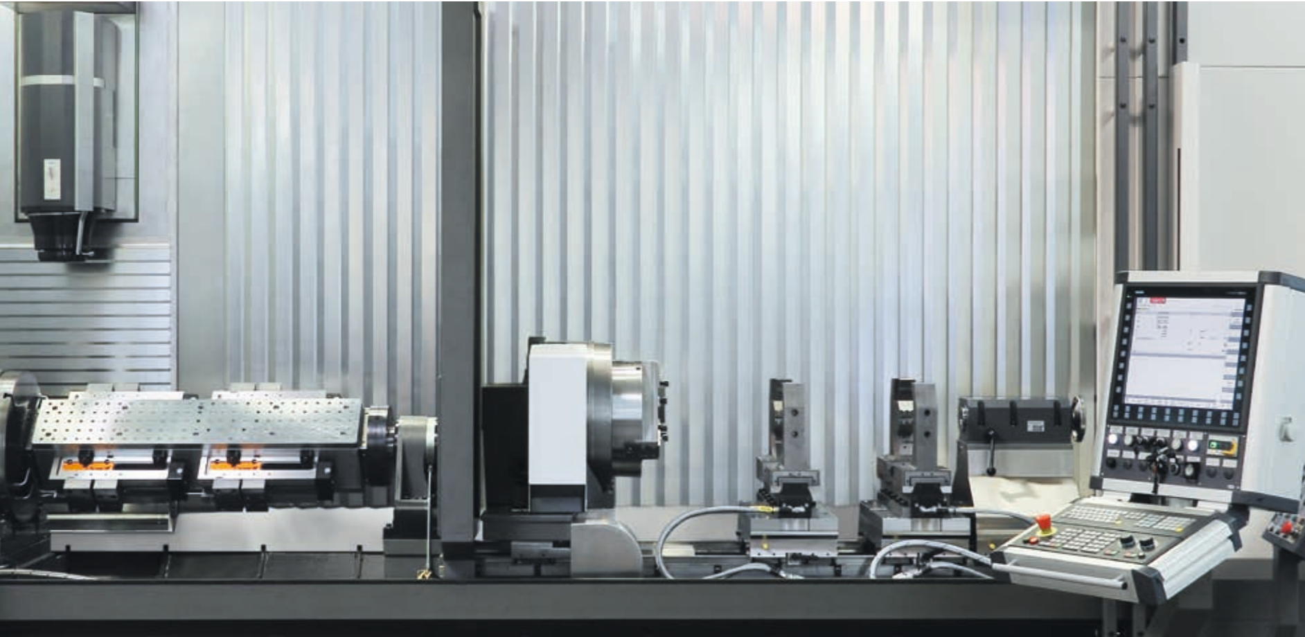
Linker Arbeitsraum: feste Anordnung von Rundtisch und Gegenlager zur Aufnahme der Spannbrücke Rechter Arbeitsraum: flexible Lösung mit Rundtisch und verschiebbarem Reitstock und Spannelementen zur Anpassung an die Werkstücklänge
