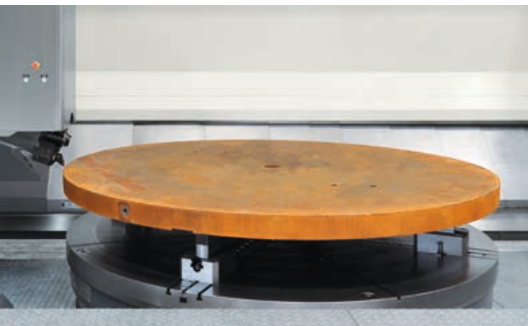
Fräsen und Drehen in einer Aufspannung: 5-Seiten- und 5-Achs-Bearbeitung großvolumiger Werkstücke durch Schwenkkopf und Rundtisch mit Planscheiben-Durchmesser 2800 mm
