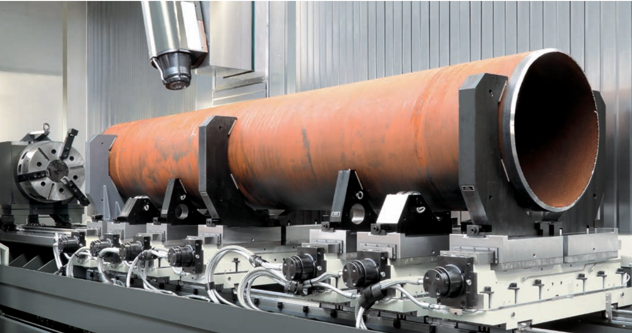
Über eine NC-Achse im Arbeitsraum verfahrbare Rundtische zur flexiblen Anpassung an die Werkstücklänge
