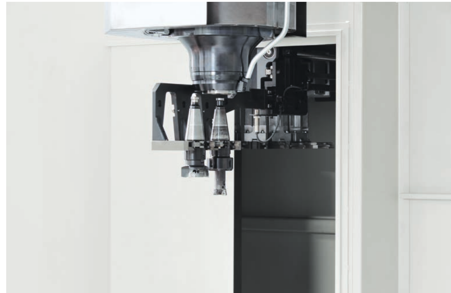
Hauptzeitparallele Werkzeugvorwahl und kurze Werkzeugwechselzeiten durch den Doppelgreifer
