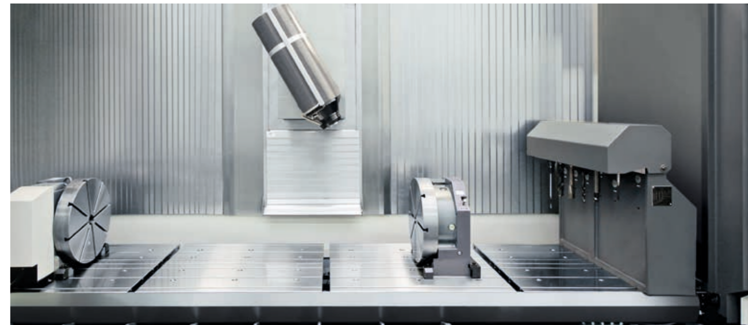
Versetzbare Pick up Station für zusätzliche Werkzeuge, links für Pendel- oder rechts für Langbettbetrieb
